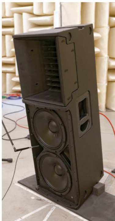
HK Audio 210 LTA bei der Nahfeldmessung an den Bassreflexports
