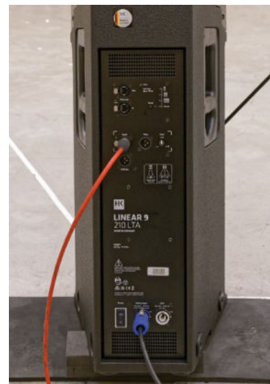
Elektronikmodul der 210 LTA Neben dem Signaleingang mit Link-Buchse gibt es noch einen zusätzlichen, über das DSP-System frei konfigurierbaren Ausgang sowie einen Netzwerkanschluss, ebenfalls mit Link-Buchse
