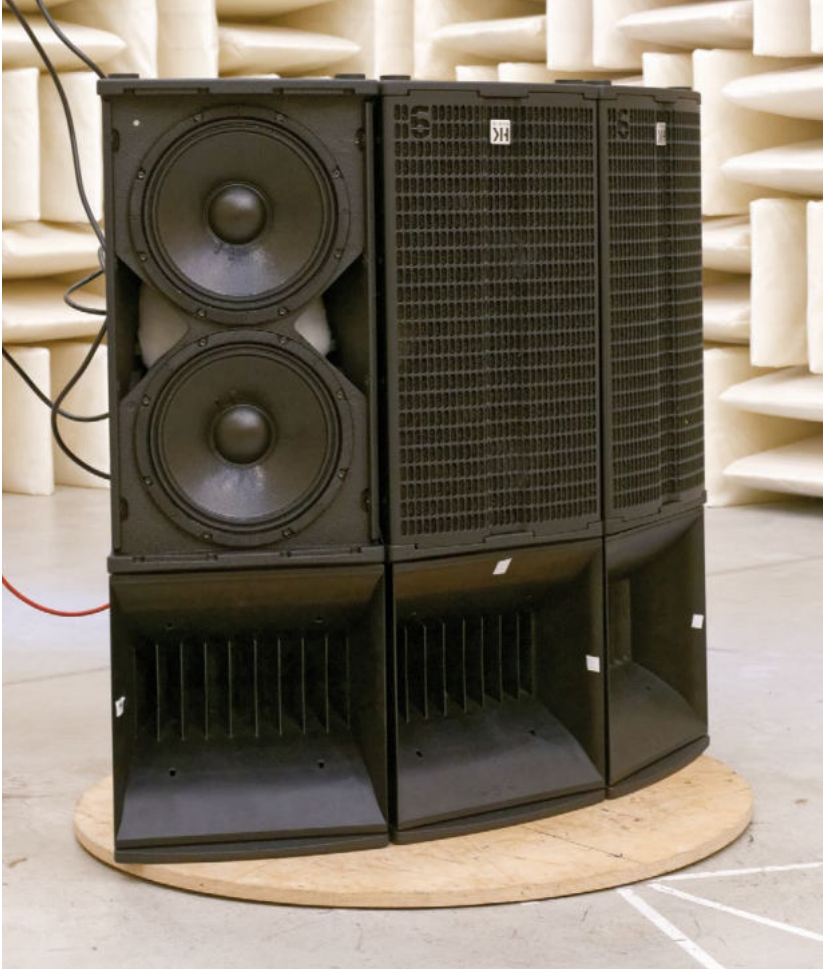
Horizontal-Array aus drei 210 LTA mit gedrehten Hochtoneinheiten und insgesamt 75° horizontalem Öffnungswinkel
