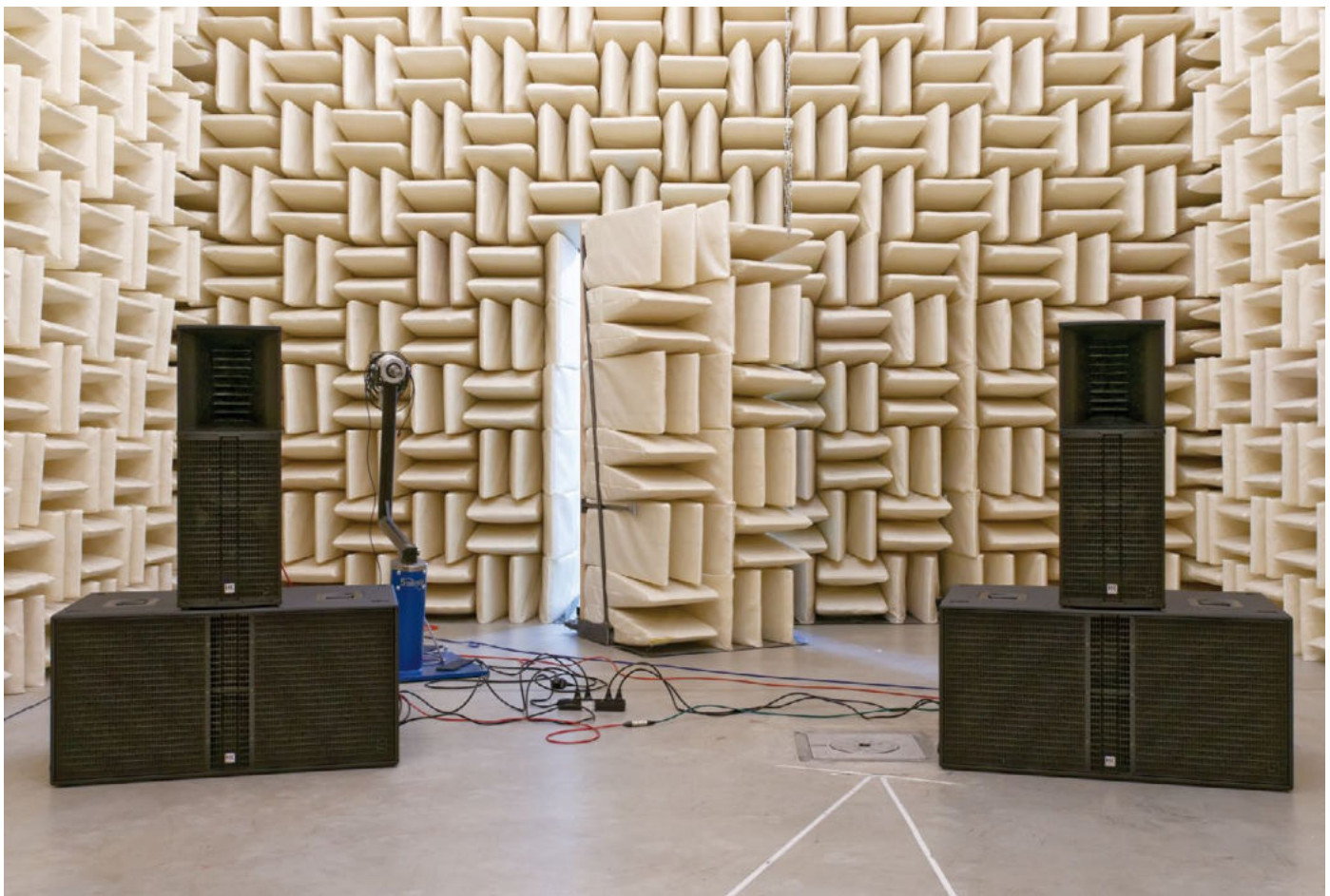
■ Hörtest mit Aufbau im reflexionsarmen Raum
