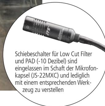
Schiebeschalter für Low Cut Filter und PAD (-10 Dezibel) sind eingelassen im Schaft der Mikrophonkapsel (JS-22MXC) und lediglich mit einem entsprechenden Werkzeug zu verstellen
