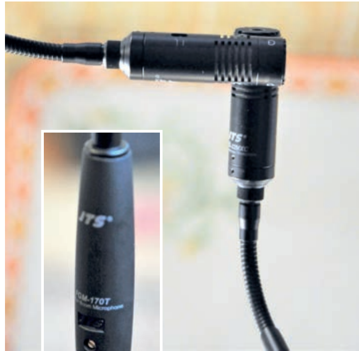
Die Overhead-X/Y-Anordnung (von unten gesehen) gelingt in etwa 2,80 Meter Höhe dank der flexiblen Schwannenhälse präzise, sicher und ohne Fixierungsprobleme
